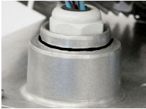
III. 27: Montage du joint torique
